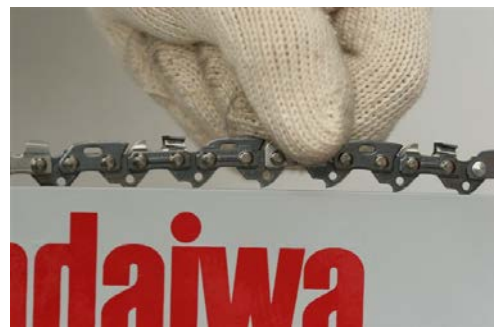
鋸鏈與鏈板之距離約 3-3.5 毫米
