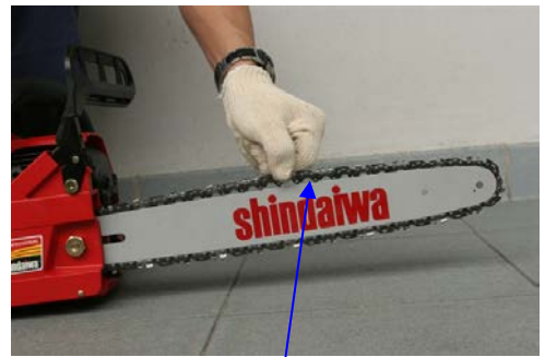
鋸鏈與鏈板之距離約 3-3.5 毫米
